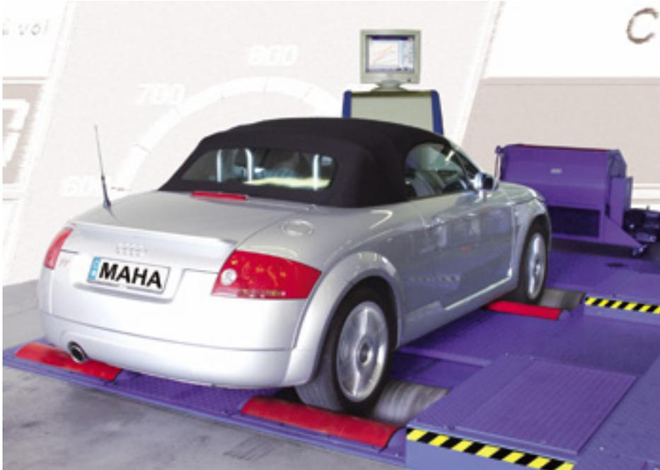
**Leistungsprüfstand mit mikroprozessorgesteuerter Recheneinheit, zur graphischen und digitalen Darstellung der Messwerte, mit verschiedenen Programmen zur optimalen Anpassung an die Prüfverfahrensaufgaben in der Werkstatt.**
